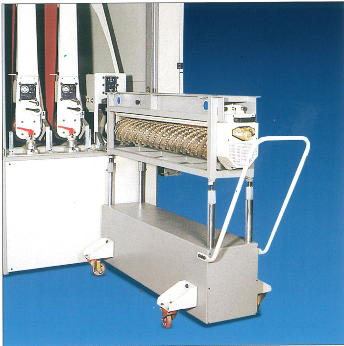
Carrello di estrazione del gruppo spessoratore Planing unit with extraction carriage Chariot pour extraction du groupe de rabotage Auszugsschlitten des Dickenhobel-Aggregates Carro de extracción del grupo regruesador Carro de extracção do grupo de desengrossar
