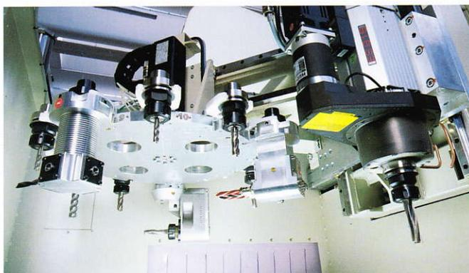
La macchina ha una carenatura totale per convogliare i trucioli in un tappeto inferiore per la raccolta totale di tutti i trucioli o sfridi prodotti dalla macchina.
