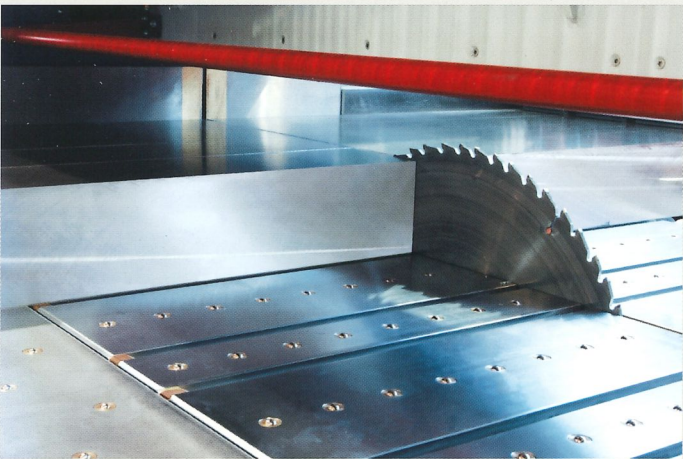
Maschinentisch mit Luftdüsen - beste Oberflächenschonung
