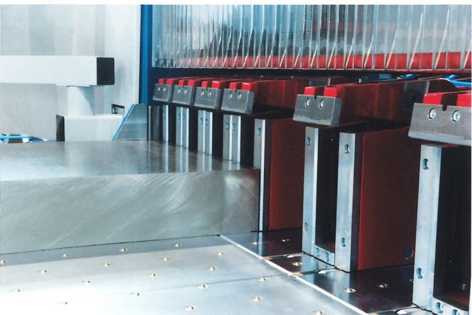
Scherenklemmer - Materialübernahme am Luftkissentisch
