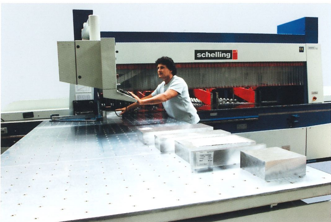
Drehtisch verschiebbar - einfachstes Arbeiten am Winkelanschlag
