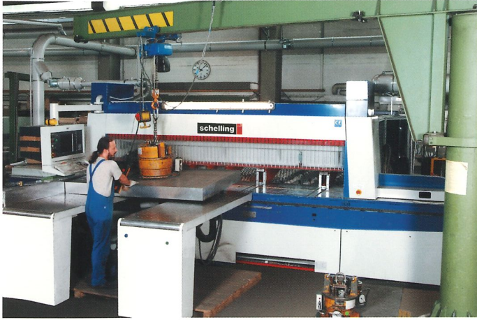
Beschickung mit Säulenkran und Saugglocke - einfachstes Handling schwerer Platten
