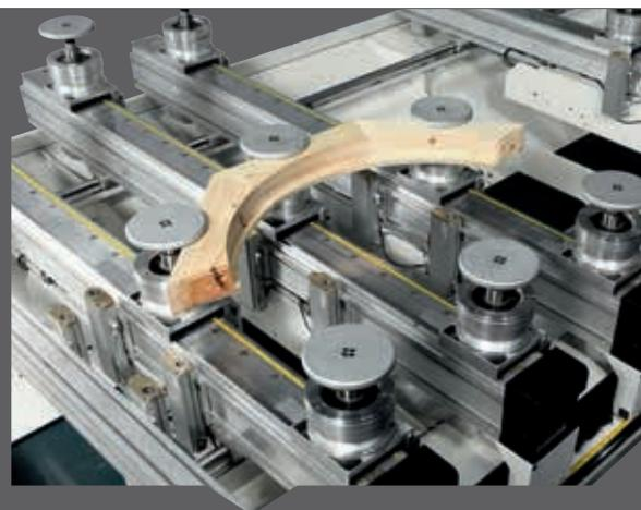
Perfekt zur Vor- und Fertigbearbeitung von Fenstern und Türen. Alle Auflagen sind mit Reinigungsdüsen versehen, die die Späne im Durchlaufbereich sowie im unteren Bereich der Werkstückeinspannung beim Wechsel der Spannzylinder entfernen.
