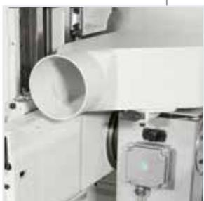
**Effiziente Späne-Absaugung** dank den auf jedes Werkzeug abgestimmten Hauben.
