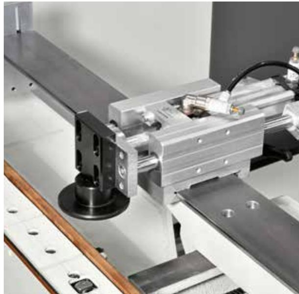
Ausrichtgerät zur perfekten Zentrierung der Platte im Maschineneinlauf.
