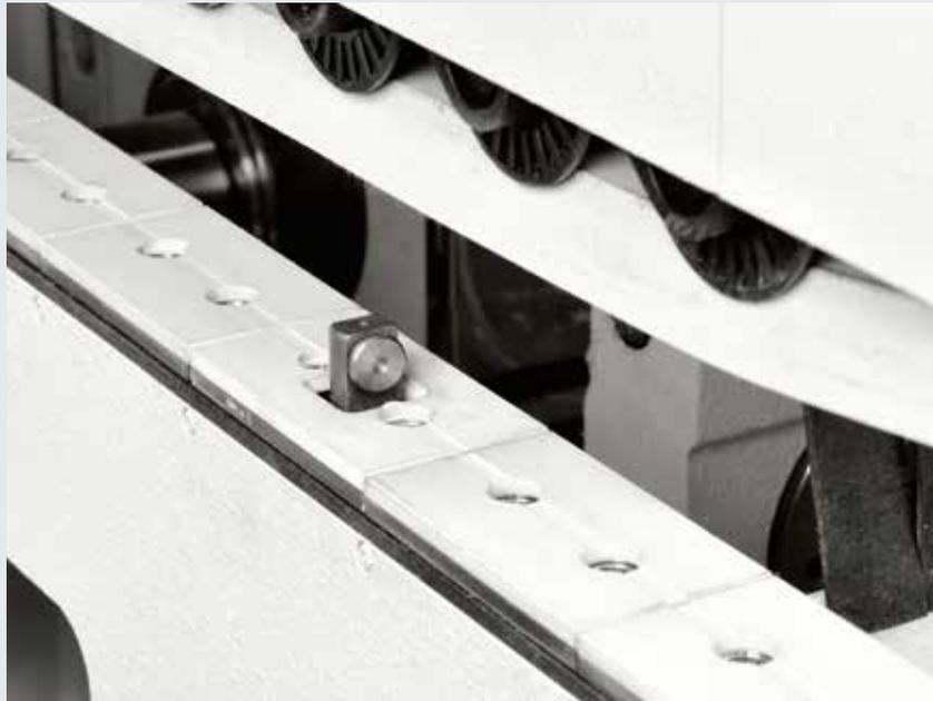
Vorschubketten sind das Ergebnis moderner Konzepte, die auf die unterschiedlichsten und strengsten Produktionsanforderungen ausgerichtet sind. Bestehend aus einer hochpräzisen Kette mit minimaler Verformbarkeit und einstellbarer Geschwindigkeit garantieren sie ein sanftes Gleiten und gleichmäßigen Vorschub sowie Präzision, Stabilität und einen geräuscharmen Betrieb.
