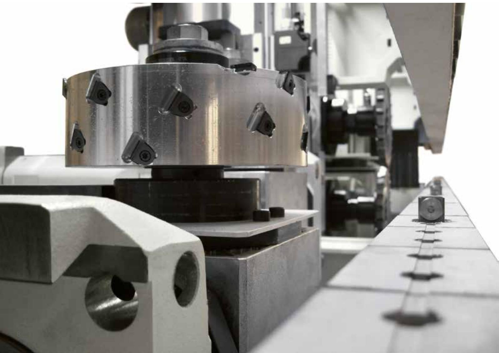
Obere Druckbalken mit Abstandrollen und Höhenverstellung nach Werkstückdicke, Abmessungen und Profil, um stets eine präzise und gleichmäßige Bewegung zu gewährleisten. **IDEAL AUCH FÜR DIE EMPFINDLICHSTE OBERFLÄCHE.**
