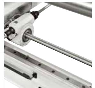
**Zuverlässigkeit und Positionierungsgenauigkeit** mit Kugelumlaufspindeln, selbstschmierenden Hochleistungsführungen und bürstenloser Schnellpositionierung.
