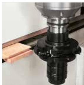
**Flexibilität und Produktivität** dank der Arbeitsaggregaten, die mit elektronischer Positionierung mit Inverter gesteuert und HSK-Aufnahme ausgestattet sind.
