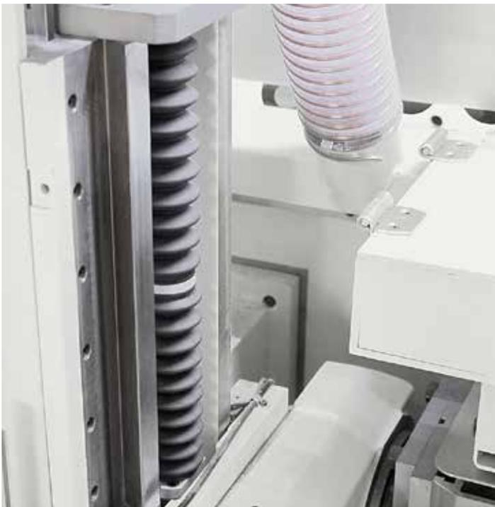
Schutzbälge gegen abrasiven Staub verlängern die Lebensdauer von mechanischen Teilen und reduzieren den Wartungsaufwand erheblich.
