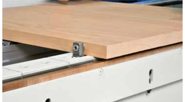
Nockenanschlätze aus verstärktem und rektifiziertem Stahl sorgen für das perfekte Besäumen.
