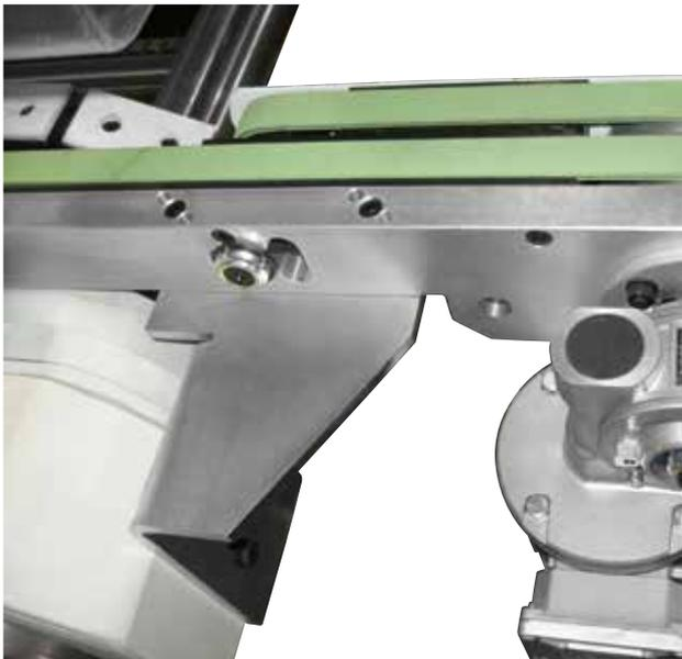
Doppelgurte bei Maschineneinlauf und / oder -Auslauf mit Drehzahl ab Inverter geregelt.
