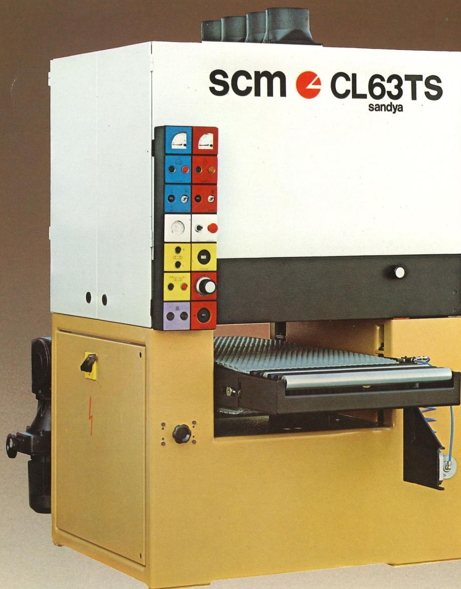
Der CL 63TS wurde speziell für die Bearbeitung von kurzen Massivholzteilen konstruiert. Er ist daher im Besonderen für den Einsatz in der Produktion von Stuhl- und Polstergestellelementen, wie auch in der Herstellung von Möbelteilen.
