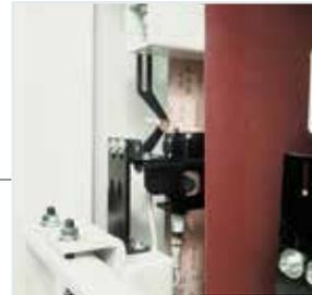
*Oszillation der Schleifbänder mit elektronischer Fotozelle für eine längere Lebensdauer des Bandes.*
