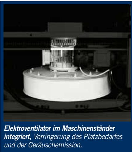
*Elektroventilator im Maschinenständer integriert, Verringerung des Platzbedarfes und der Geräuschemission.*
