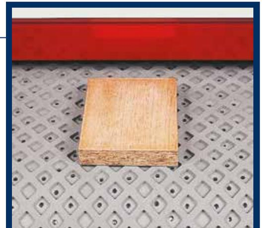
*Vorschubteppich mit einem besonderen Gummiprofil in Rhombusform: bessere Übertragung der Vorschubkraft auf das Werkstück und optimale Führungsstabilität.*
