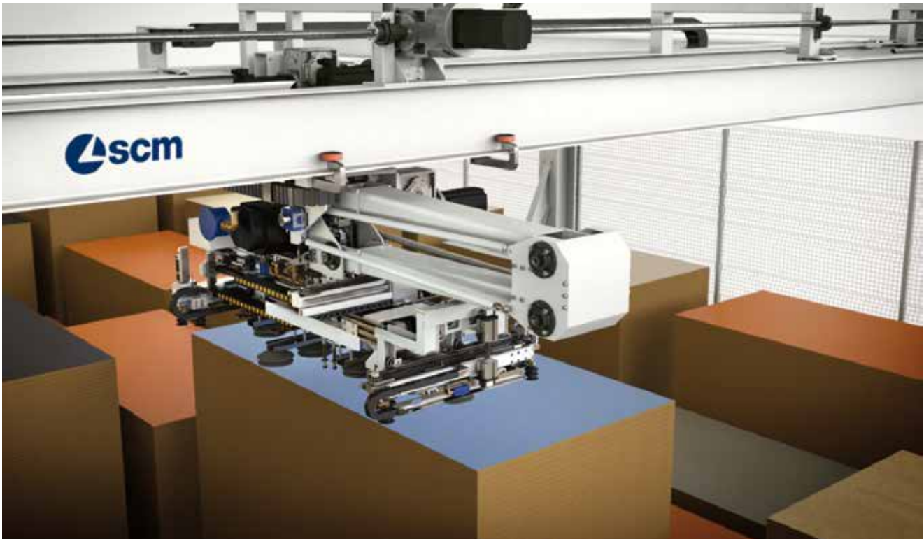
Braccio a ventose progettato per integrare i dispositivi di gestione dei pannelli sottili.
