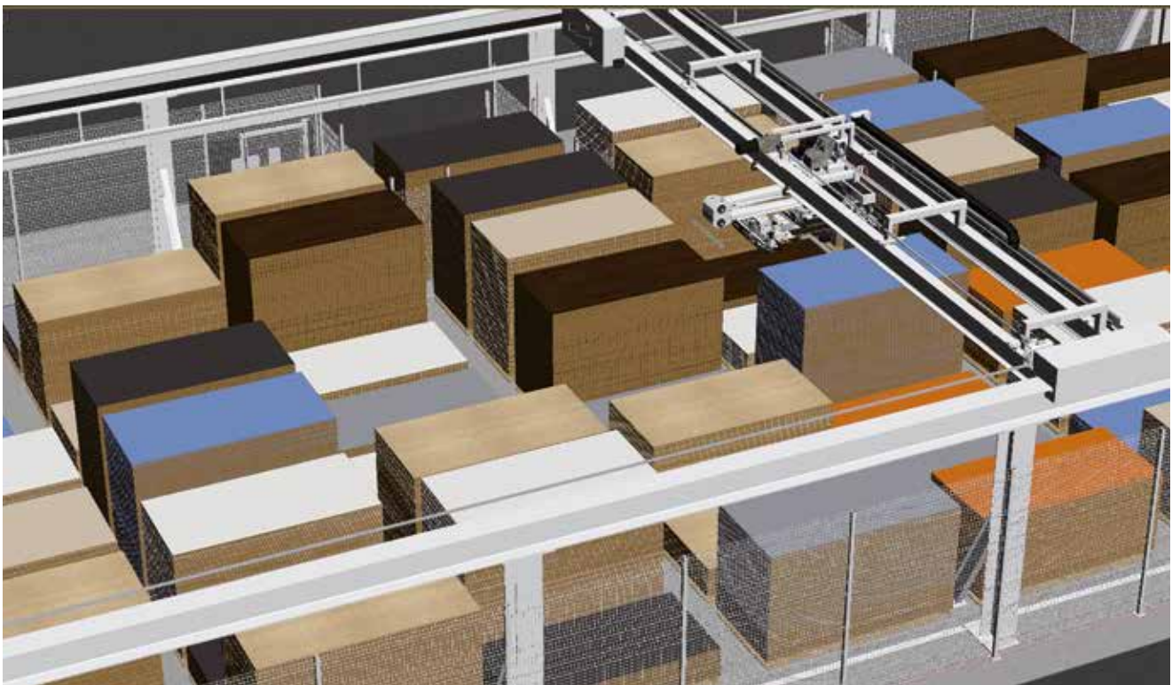
La struttura in acciaio permette movimentazioni senza vibrazioni anche nei magazzini di grandi dimensioni.
