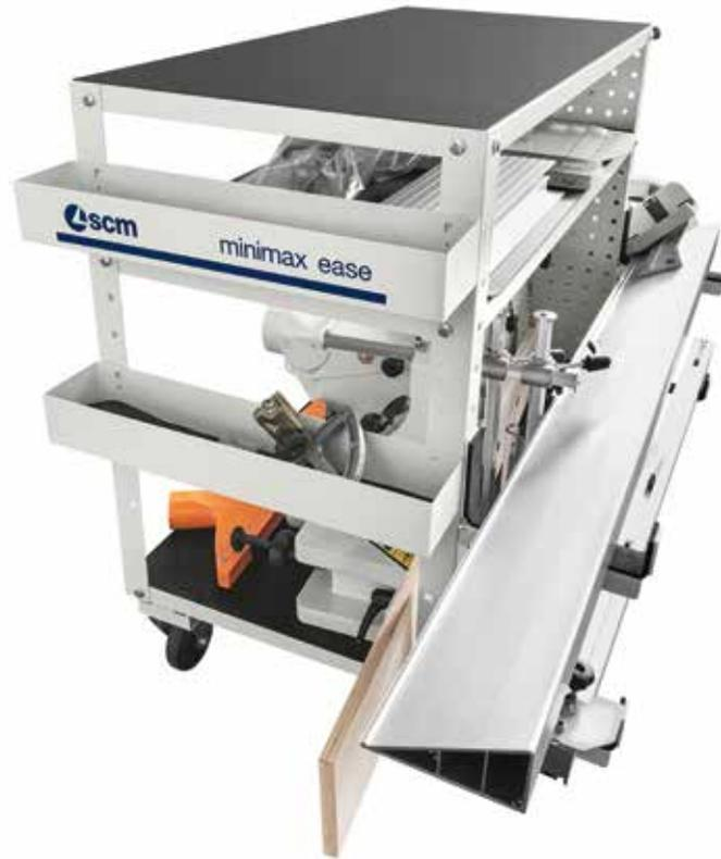
Ermöglicht die Lagerung einer Vielzahl von Zubehöerteilen wie z.B.: Abrichtanschlag, Teleskoplineal, Fräsanschlag, Fräsaggregat, usw.
