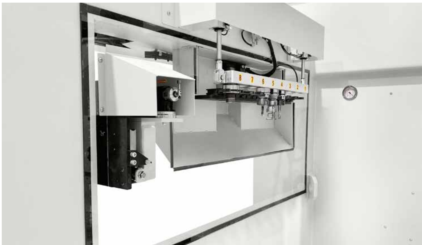
Reduzierte Stillstandzeiten durch das auf der linken Seite der Maschine angeordnete "Pick-up" Werkzeugwechsler.
