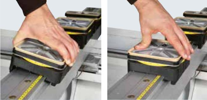
Es ist möglich Sauger oder Spanner mit einer einfachen Handbewegung hinzuzufügen oder zu entfernen; die Anzahl und die Position werden automatisch erfasst.
