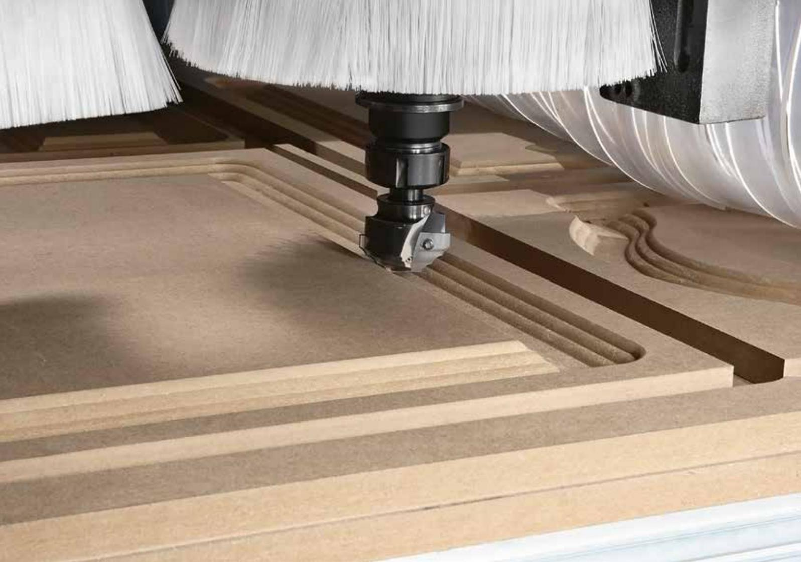
*ptimale Bearbeitungspräzision* mit der 3-achsigen Elektroschindel bis zu 24.000 U/min.
