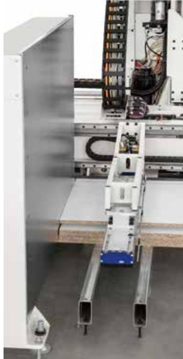
Höchste Positioniergenauigkeit auf der Arbeitsfläche dank des Plattenvorrichtungssystems direkt auf dem Ladestapel.
