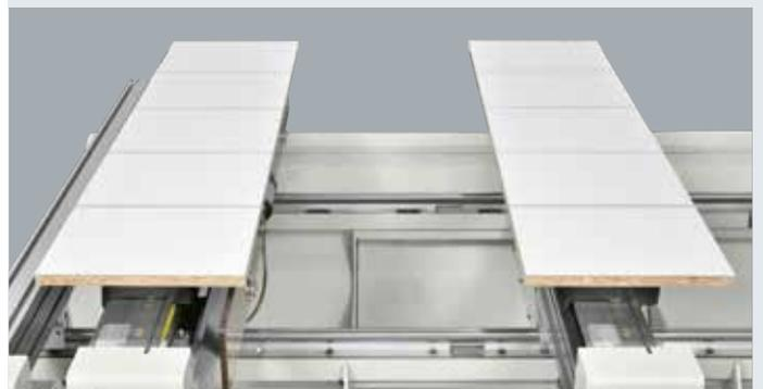
Aus einer einzigen Platte können mehrere Werkstücke gefertigt und automatisch neu positioniert werden, um alle notwendigen Bearbeitungen auszuführen, ohne dabei je den Produktionszyklus zu unterbrechen. Danach werden die Werkstücke wieder in die Ausgangsposition gebracht, um das Entladen vom Arbeitstisch zu erleichtern.
