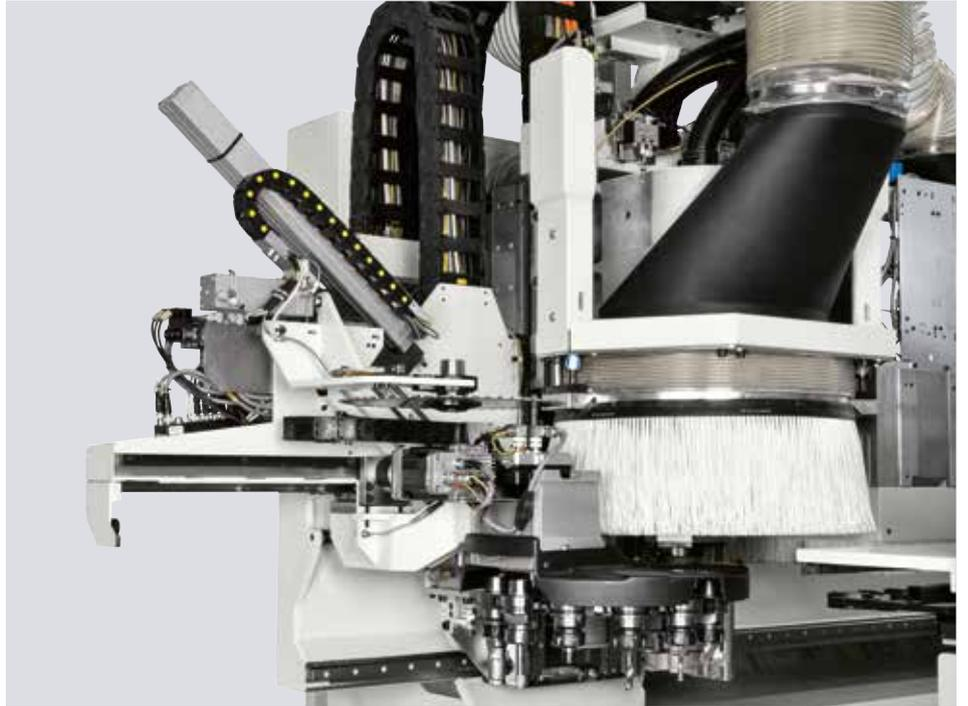
Der an der Seite der Elektroschneidspindel eingestellte **Werkzeugwechsler "on-board" VELOCE**, mit 12 oder 16 Positionen, ermöglicht das Auswechseln der Werkzeuge in maskierter Zeit. Auch mit „pick-up“ für ein **Sägeblatt**, zusätzlich zu den anderen Werkzeugen, verfügbar.
