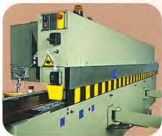
Guard on feed belt. Schutz auf der Vorschubkette.
