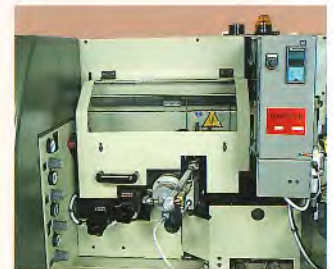
Guard on edge banding feeder complete with emergency microswitch. Schutz auf dem Kantenmagazin mit Sicherheitsschalter.
