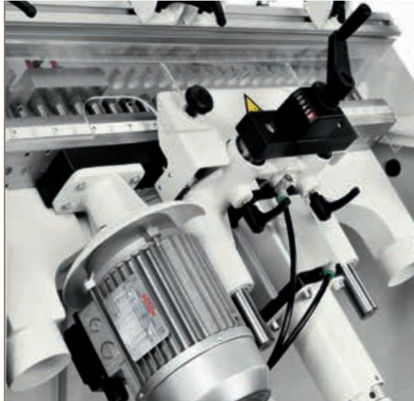
Laboratorio siempre en orden con la aspiración de las virutas mediante campana en el cabezal de taladro y colector en la bancada
