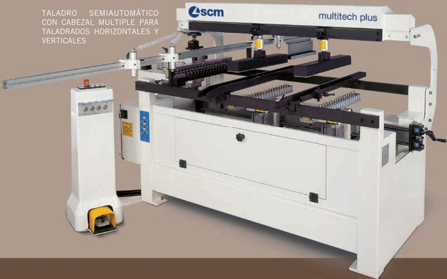
Productividad y flexibilidad a los máximos niveles, gracias al cabezal horizontal con 21 portabrocas (multitech 3 plus)
