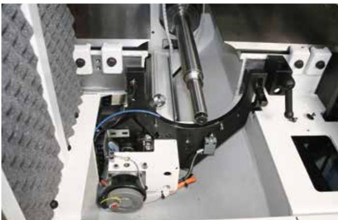
In der Regel sind die Verfahren zum Abziehen sehr zeitaufwendig und erfordern qualifizierte Arbeitskräfte. Um diese Eingriffe einfach, schnell und präzise durchzuführen, verschiebt sich der Stein auf Superset TM automatisch, sowohl axial als auch radial, mittels eines elektronischen Systems mit vor-eingestellten Geschwindigkeiten, je nach Stein- bzw. Werkzeug-Typ und nach Abtragung.
