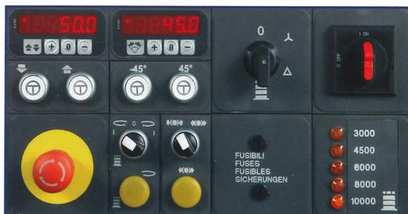
E' possibile regolare elettricamente l'altezza e l'inclinazione dell'albero toupie.
