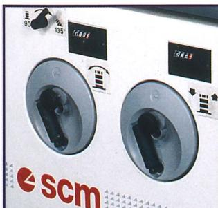
Il posizionamento dell'albero rispetto al piano di lavoro avviene manualmente mediante volantini posizionati sul fronte macchina. I lettori digitali meccanici garantiscono il raggiungimento di una precisione al decimo di millimetro sui posizionamenti riducendo notevolmente i passaggi di prova.
