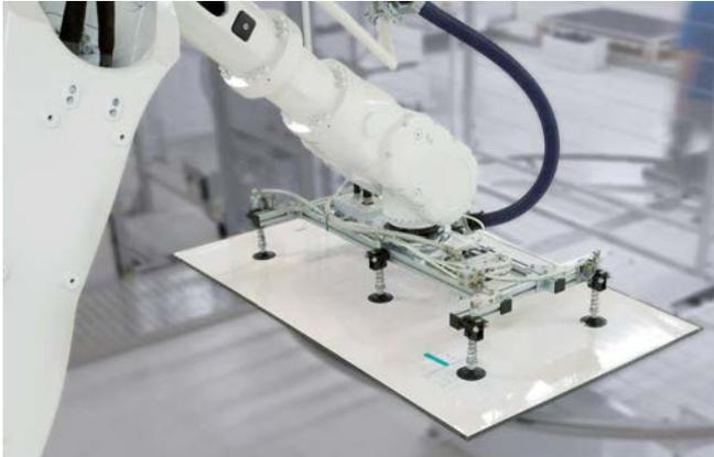
Vakuum-Saugspinne SSP bei der Handhabung von Modulglas
