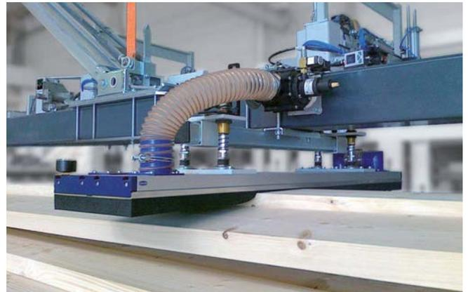
Vakuum-Flächengreifsystem FMP als Doppelgreifer bei der Handhabung von Konstruktionsholz
