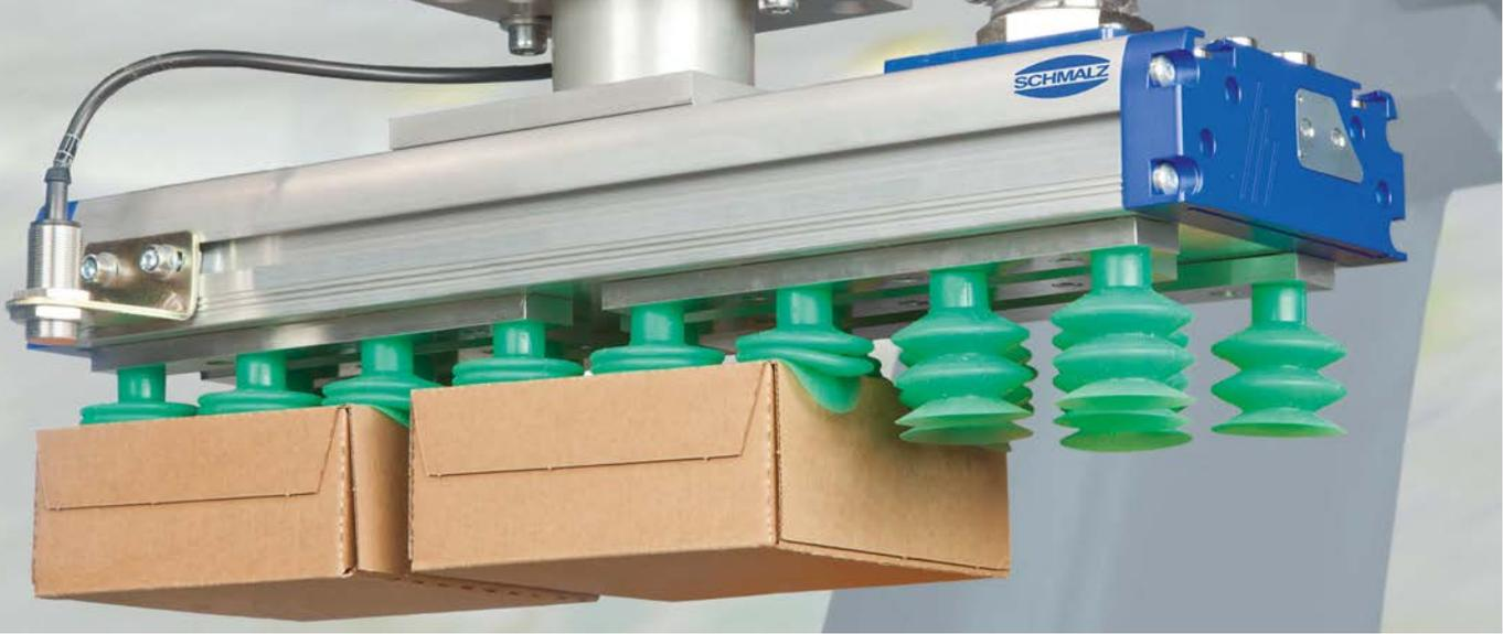
Vakuüm-Flächengreifsystem FMP beim Beladen von Versandkartons mit kleineren Schachteln
