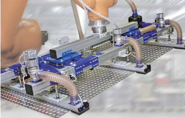
Vakuum-Saugspinne SSP bei der Handhabung von Blechen
