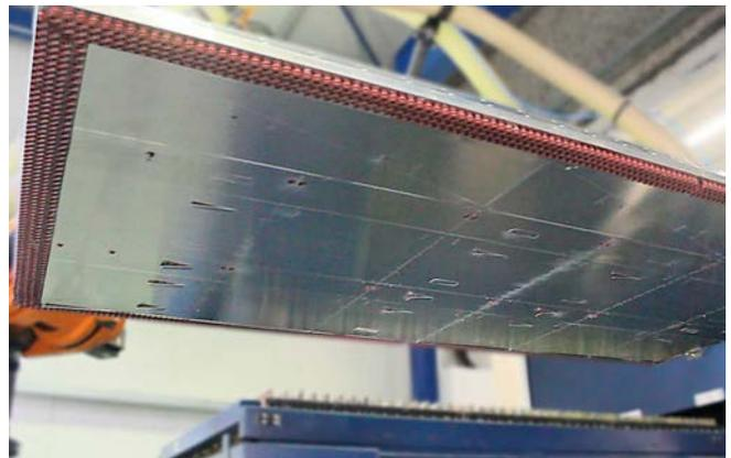
Vakuum-Lagengreifsystem SPZ zum Abstackeln von Zuschnitten in der Laser-Fertigung
