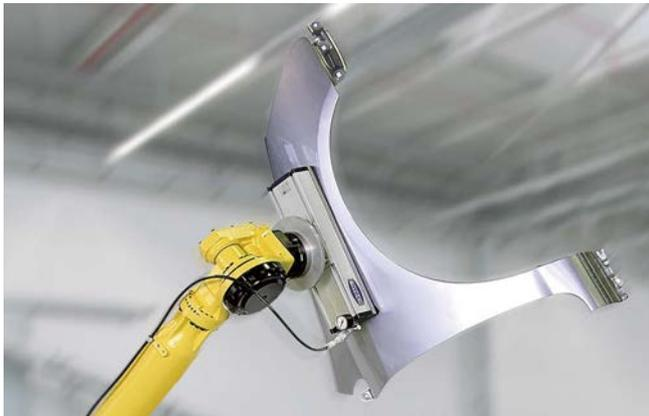
Vakuum-Flächengreifsystem FXP bei der Handhabung von Karosserieteilen im Presswerk
