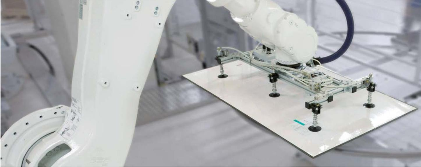
**Solar** | Vakuum-Saugspinne SSP bei der Handhabung von Modulglas
