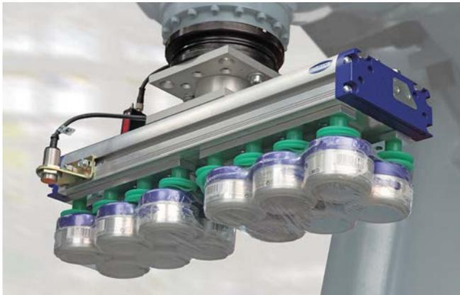
Vakuüm-Flächengreifsystem FXP bei der Handhabung von folienumwickelter Ware
