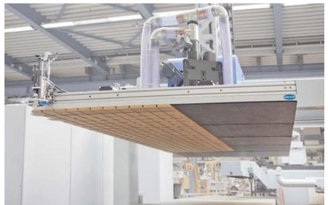
Schmalz Nesting-Greifer SPZ-NG zum Ab stapeln von kompletten Werkstücklagen in der Nesting-Fertigung
