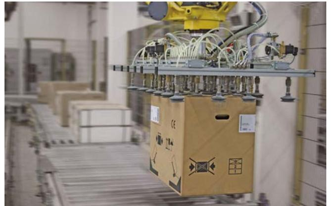
Vakuum-Saugspinne SSP beim Kommissionieren von Kartons in einem Warenverteilzentrum
