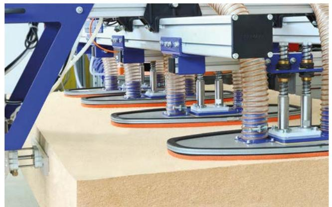
**Baustoffe** | Vakuum-Saugspinne SSP bei der Handhabung und Vereinzelung von porösen Dämmstoffplatten
