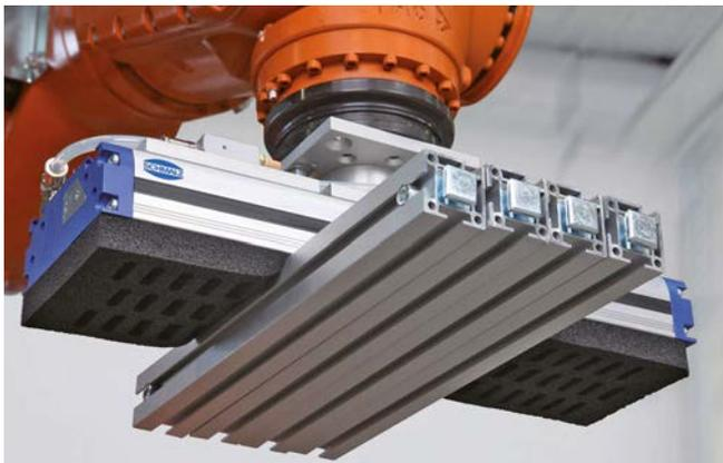
Vakuum-Flächengreifsystem FMP bei der lagenweisen Handhabung von Profilen
