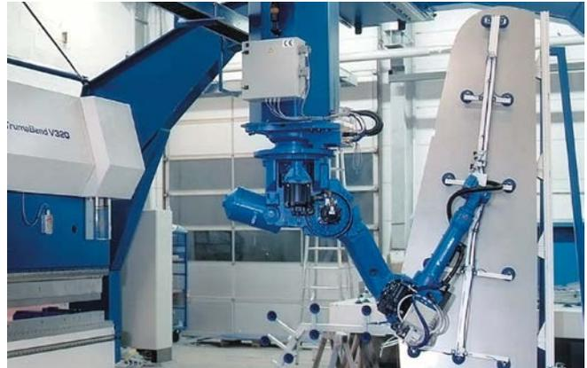
Vakuum-Saugspinne SSP bei der Handhabung von Blechzuschnitten
