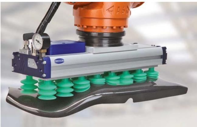
**Faserverbund** | Vakuum-Flächengreifsystem FXP bei der Handhabung von CFK-Formteilen
