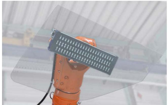
Vakuum-Flächengreifsystem FXP bei der Handhabung von Automobilglas in der Fahrzeugmontage
