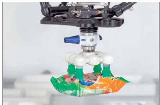
Vakuum-Endeffektor VEE mit Balgsauggreifern SPB4f bei der Handhabung von Beutelverpackungen mit starker Faltenbildung und geringem Füllgrad
