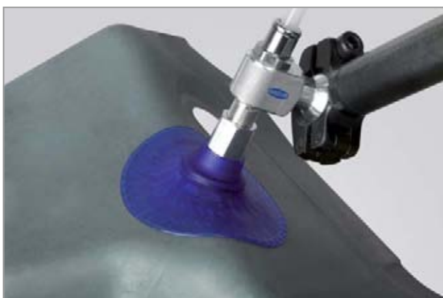
Glockensauggreifer SAXM bei der Handhabung von geformten Blechteilen
