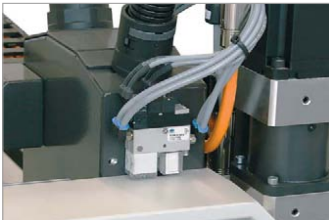
Zentrale Vakuum-Erzeugung durch Kompaktejektoren SCPM
