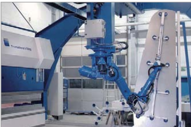
Flachsauggreifer SAF bei der Handhabung von Blechteilen
