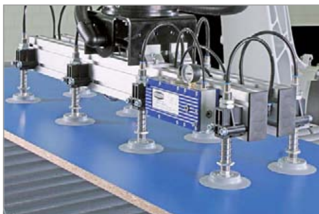
Saugplatten SPU bei der Handhabung von beschichteten Spanplatten
