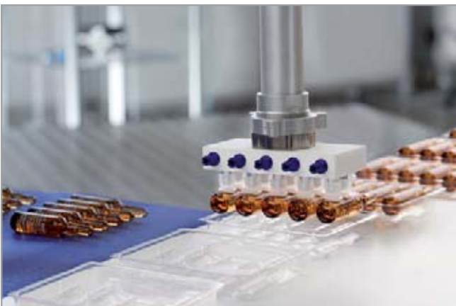
Vakuum-Erzeugung durch Ejektormodule SEP bei der Handhabung von Ampullen
