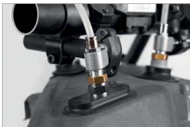
Flachsauggreifer SAOF HT2 bei der Handhabung von geformten Blechteilen
