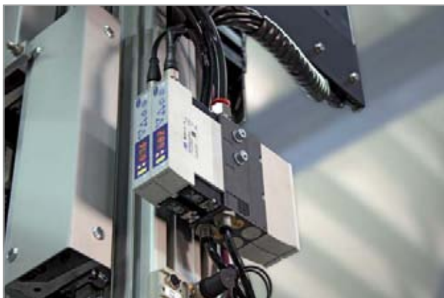
Zentrale Vakuum-Erzeugung durch Kompaktejektoren SMPi
