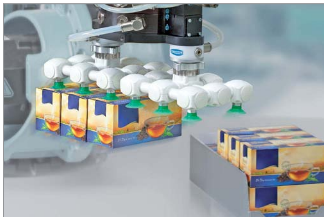
Vakuum-Endeffektor mit Flachsauggreifern SPF bei der Handhabung von Teekartons
