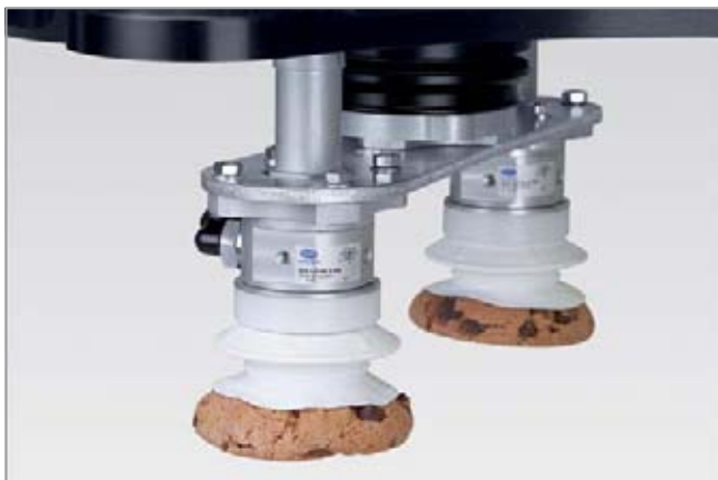
Strömungsgreifer SCG bei der Handhabung von Backwaren
