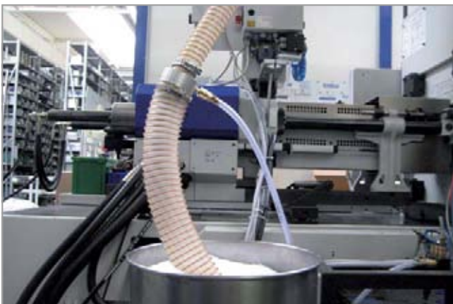
Vakuum-Erzeugung durch Förderejektoren SEC bei der Granulatförderung
