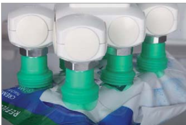
Balgsauger SPB4 bei der Handhabung von Beuteln und formlabilen Verpackungen
