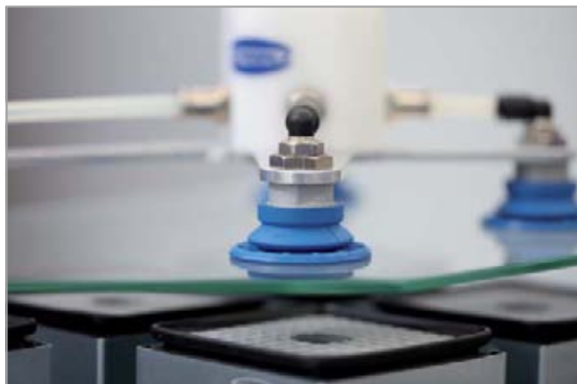
Balgsauggreifer SAB HT1 bei der Handhabung von Glas
