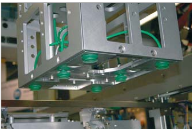
Balgsauggreifer SPB2 beim Einsatz in einer Sideloadung-Maschine
