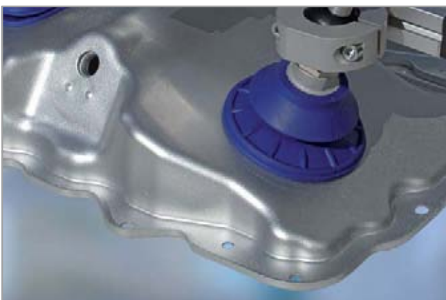
Balgsauggreifer SAB bei der Handhabung von Automobil-Karosserieteilen
