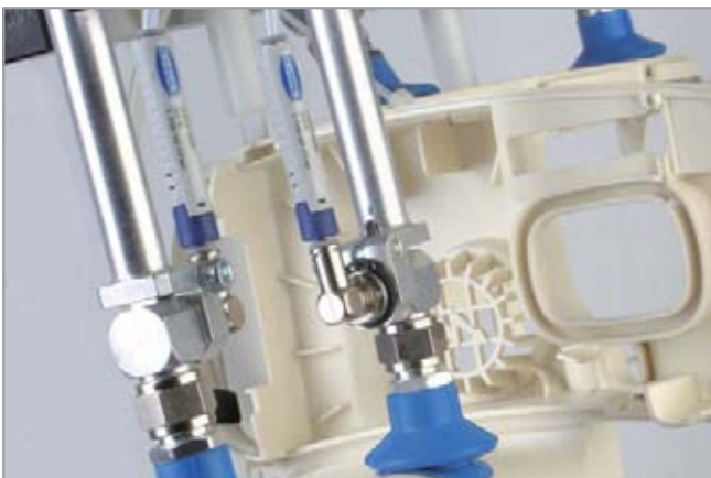
Dezentrale Vakuum-Erzeugung durch Inline-Ejektoren SLP bei der Handhabung von Kunststoff-Spritzgussteilen
