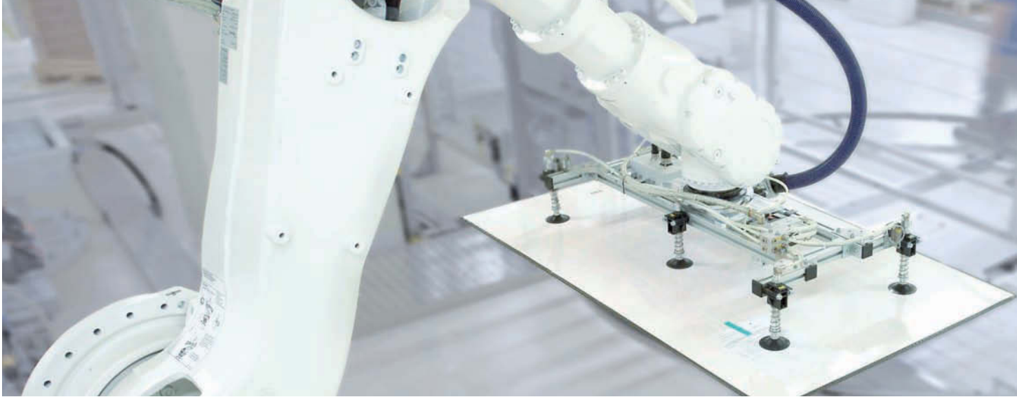
Solar | Vakuum-Saugspinne SSP bei der Handhabung von Modulglas
