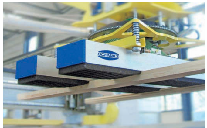
Vakuum-Flächengreifsysteme SBX am Industrieportal zur Handhabung von Holzbrettern
