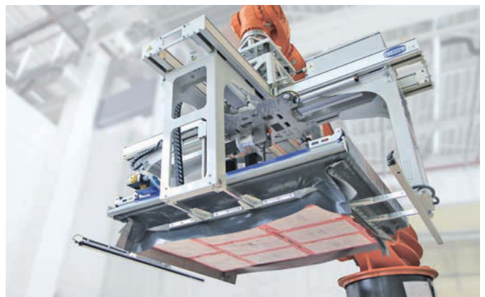
Intralogistik | Vakuum-Lagengreifsystem SPZ-M-C zur Handhabung von verschiedensten Produktlagen in der Warenhaus- und Intralogistik
