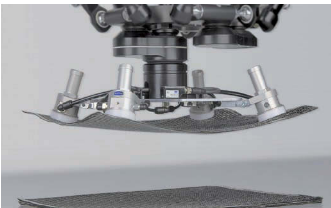
Composite | Greiferspinne SCG bei der Handhabung von biegeschlaffen Composite-Textilien
