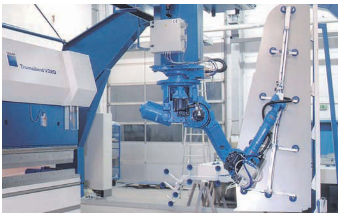
Karosseriebau | Vakuum-Saugspinne SSP bei der Maschinenbe- und entladung von Blechzuschnitten in der Landmaschinen-Karosseriefertigung
