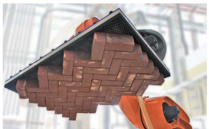
Baustoffe | Vakuum-Lagengreifsystem SPZ bei der Handhabung von Klinkersteinen
