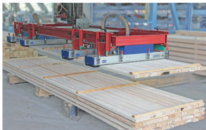
Holz | Vakuum-Saugspinne SSP an einem Industrieportal zur Handhabung von sägerauen Holzbrettern
