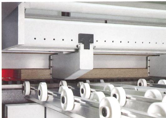
Una barriera a settori indipendenti, associata ad una barra di protezione di emergenza attiva, assicura una efficace protezione antinfortunistica. La barriera a settori indipendenti assicura inoltre la massima efficacia del sistema di aspirazione polveri (Certificazione FPH-AZ.: 001/97 del 13.06.1997).
