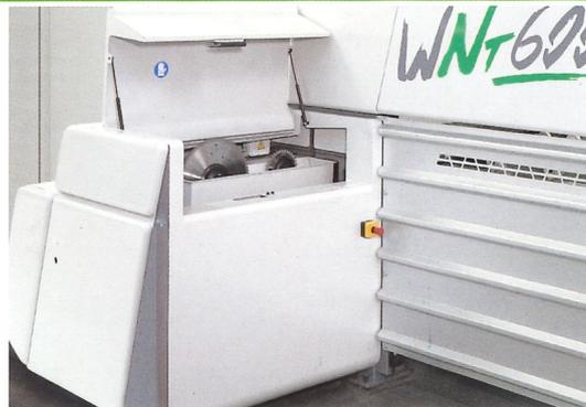
Il particolare design del carter del cambio utensili consente un ampio ed agevole accesso per la sostituzione delle lame.
