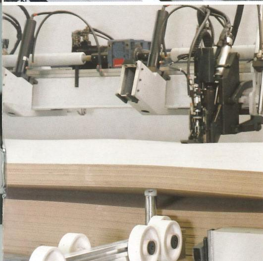
Rulliere di carico folli o motorizzate consentono il carico e l'eventuale scarico laterale o posteriore delle pile di pannelli. A richiesta sono inoltre disponibili speciali soluzioni per la movimentazione delle pile e permettere l'introduzione e l'evacuazione dei pannelli a 90°.
