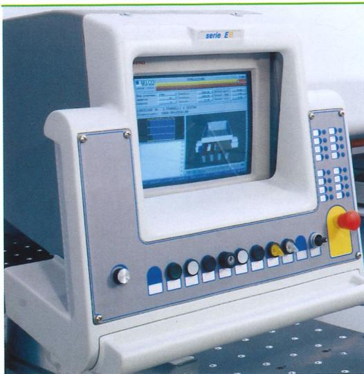
Controllo numerico con PC e video da 15" a bordo macchina e sistema operativo multitasking, "Windows '95" o "Windows '98".
