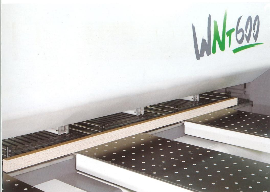
Dispositivo con raggio laser per identificare chiaramente la linea di taglio sui pannelli da sezionare.
