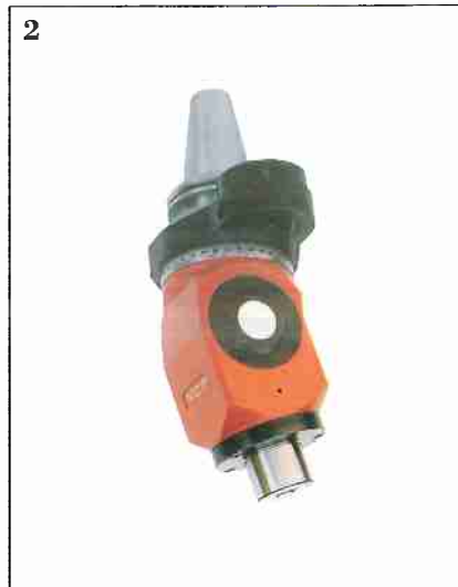
2 Gruppo a forare con attacco ISO 30, girevole a 360° in manuale, con inclinazione fissa a 15°. Drilling ISO 30 group, turning at 360° in manual with steady inclination at 15°. Groupe à percer, attache ISO 30, tournant à 360° en manuel, inclination fixe à 15°. Bohraggregat ISO 30, 360° drehbar und manuell; feste Schrägstellung 15°.
