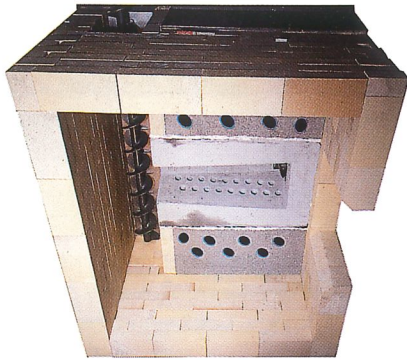
Schamottierte Brennkammer mit Entschungsschnecke/Graben
