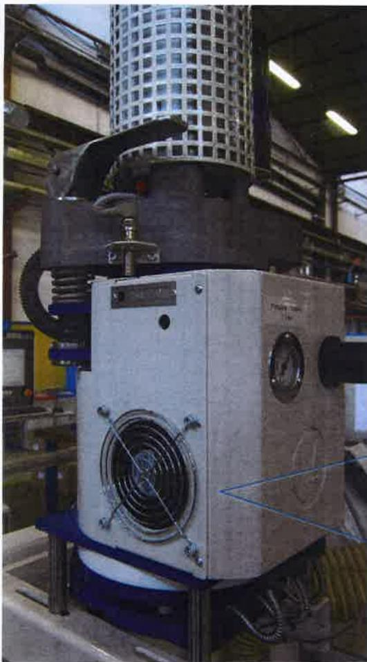
Dispositivo CFS che attenua l'invecchiamento e la viscosità della colla nel tempo
