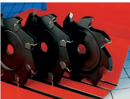
On fraise ensuite des rainures au verso des panneaux composites en forme de V ou de U avec des plaques réversibles spéciales. La forme de la rainure est un facteur qui influence le rayon de pliage.
