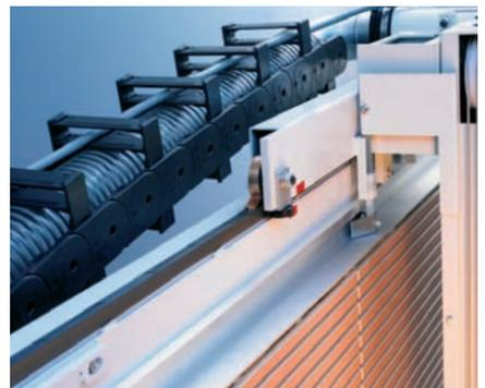
Une solution technique claire et nette : la chaîne de câble du modèle STANDARD. Elle sépare le guidage de flexibles et les câbles électriques, et peut également abriter de grandes quantités de câbles. Grâce à leur guidage, les pièces, flexibles et câbles sont à peine sollicités. Chaque détail de la scie STANDARD est conçu pour durer.
