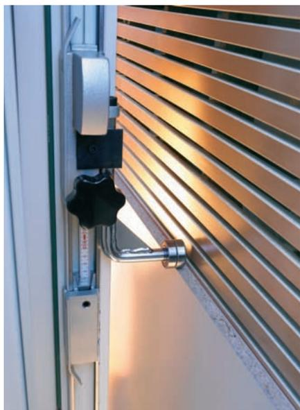
La butée à liteaux montée de série avec appui à rouleaux pour la protection des arêtes facilite les coupes répétées.
