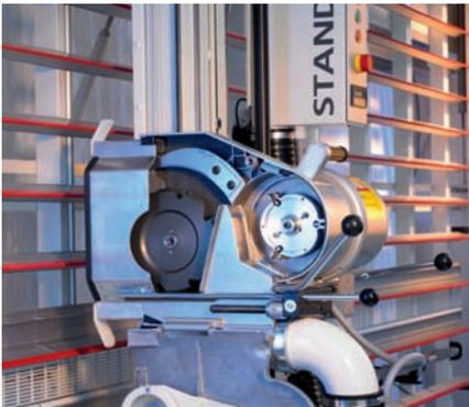
Pour de nombreuses commandes, les travaux de rainurage et de fraisage sont absolument nécessaires. Vous pouvez effectuer ces travaux sans problème sur la scie STANDARD. Vous pouvez travailler des pièces en bois et des panneaux en matériaux composites.
