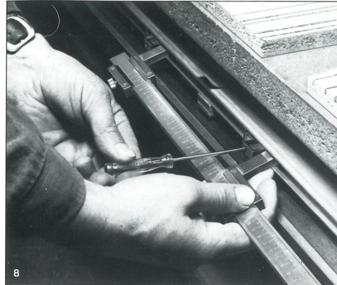
8 Schnelles Einstellen der Nocken für die Schnittpositionen mit Hilfe einer Schiebellehre. Durch Schnellspanner können die Programmschienen gegen andere vorbereitete Schienen blitzschnell ausgetauscht werden.
