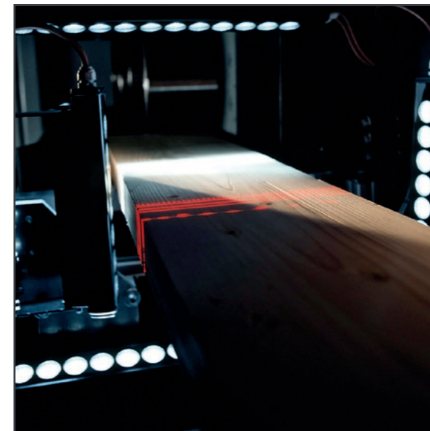
► Die Multisensor-Scanning-Technologie scannt die Werkstücke zwecks optimaler Holznutzung.
