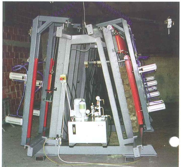
Die Presse SLP ist fuer Breiten - und Dicken - Verleimung von Holz zu verschiedenen (Trägern, Fensterprofilen) bestimmt, wobei die Leimfugen luftgetrocknet werden. Sie ist für Arbeitsbreite von 60 - 180 mm und Längen von 3000 - 6000 mm ausgelegt. In der Länge kann sie jederzeit ausgebaut werden.
