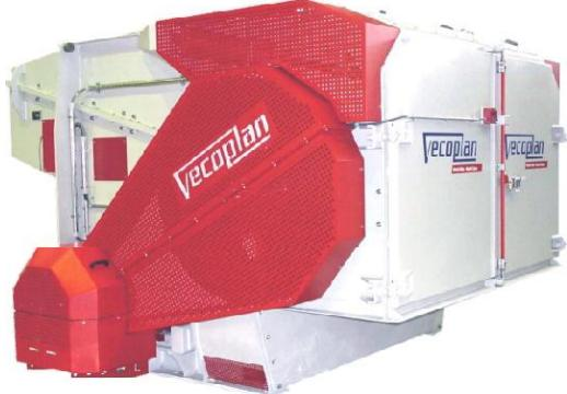
Sehr leistungsfähige Zerkleinerungsmaschine für die Nachzerkleinerung mit konstanter Rotor-drehzahl von ca. 410 UpM. Hauptantrieb über E-Motor, Turbokupplung und Riementrieb mit elektronisch überwachter Rutschnabe.
