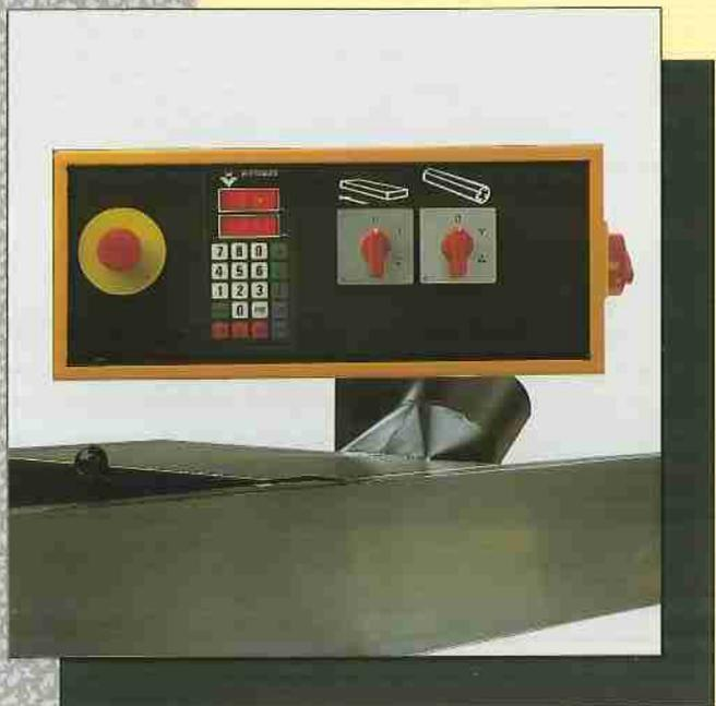
Alle schakelaars zijn gemakkelijk bereikbaar: noodstop / automatisch op - en neergaande beweging vandiktetafel met fijninstelling en elektronisch digitale aanduiding met geheugen / doorvoer / schaafas / algemene schakelaar.
