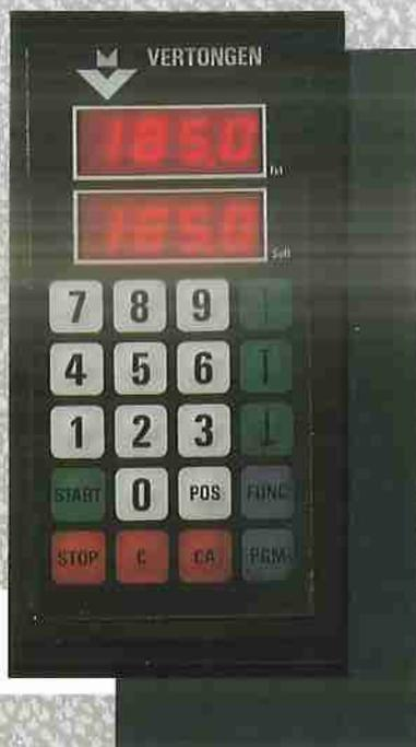
De gewenste schaafhoogte kan rechtstreeks ingegeven worden op het toetsenbord. Automatisch op- en neergaande beweging van vandiktetafel met fijnstelling en elektronisch digitale aanduiding. Eveneens zijn 99 verschillende veel gebruikte schaafdikten vooraf te programmeren en gemakkelijk op te roepen. De vandiktetafel gaat ook terug naar de vorige positie met de starttoets na manuele verstelling.
