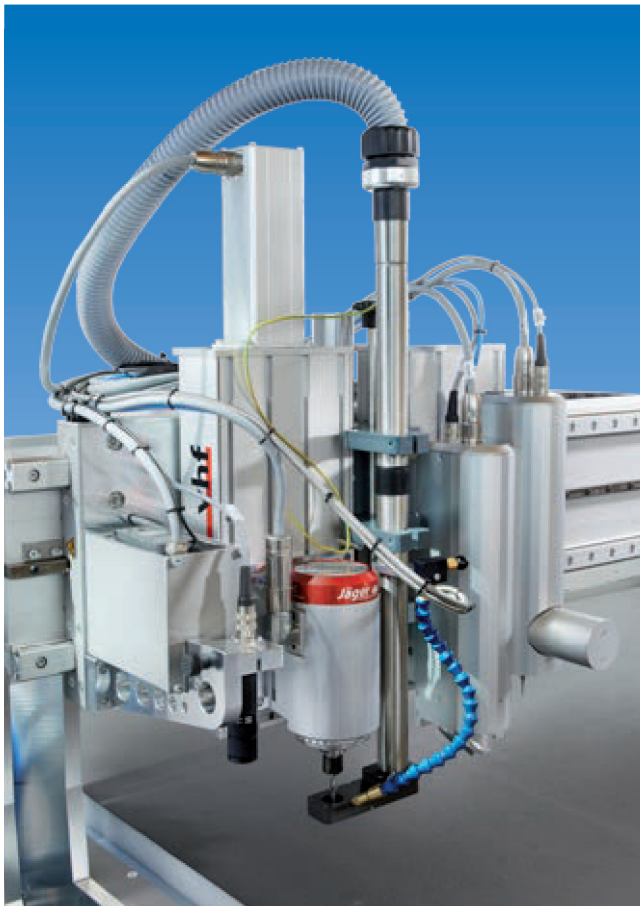
Beim häufigen Wechsel der Bearbeitungsart empfiehlt sich das Multi-Aggregat (rechts neben der Absaugvorrichtung).
