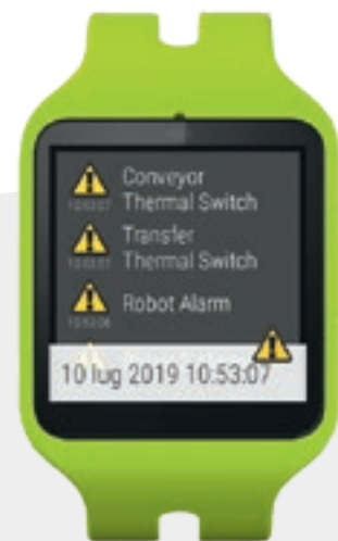
NOTIFICATIONS Liste des alarmes ou demandes d'entretien. Chaque fois que la machine signale un problème ou une demande d'entretien, la Viet Watch vibre et affiche une icône de danger sur son écran.
