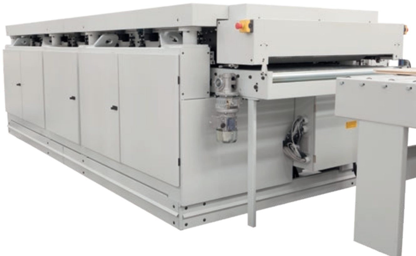
Vue extérieure de la machine spéciale Valeria inférieure à 8 groupes opérateurs brosse.
