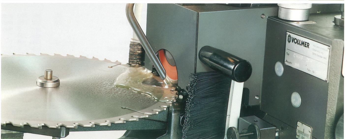
Um jederzeit die hohe Schneidleistung von hartmetallbestückten Kreissägeblättern zu gewährleisten, müssen ausgebrochene Zähne wieder ersetzt werden. Für diese Aufgabe bietet Vollmer mit der Lötteinrichtung LG und der Flankenschleifmaschine CHHF eine besonders wirtschaftliche Lösung an.
