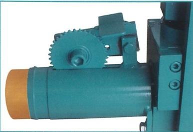
El control de la longitud de las briquetas se regula automáticamente. Una vez alcanzada la fuerza de compresión, las tenazas abren automáticamente y el control de la longitud de briquetas automático mide la longitud de la briketa redonda al evacuarla.
