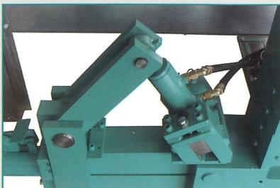
Mediante tornillos de ajuste se asegura un ajuste sencillo de la fuerza de apriete mecánica de las tenazas, garantizando así períodos de parada cortos.
