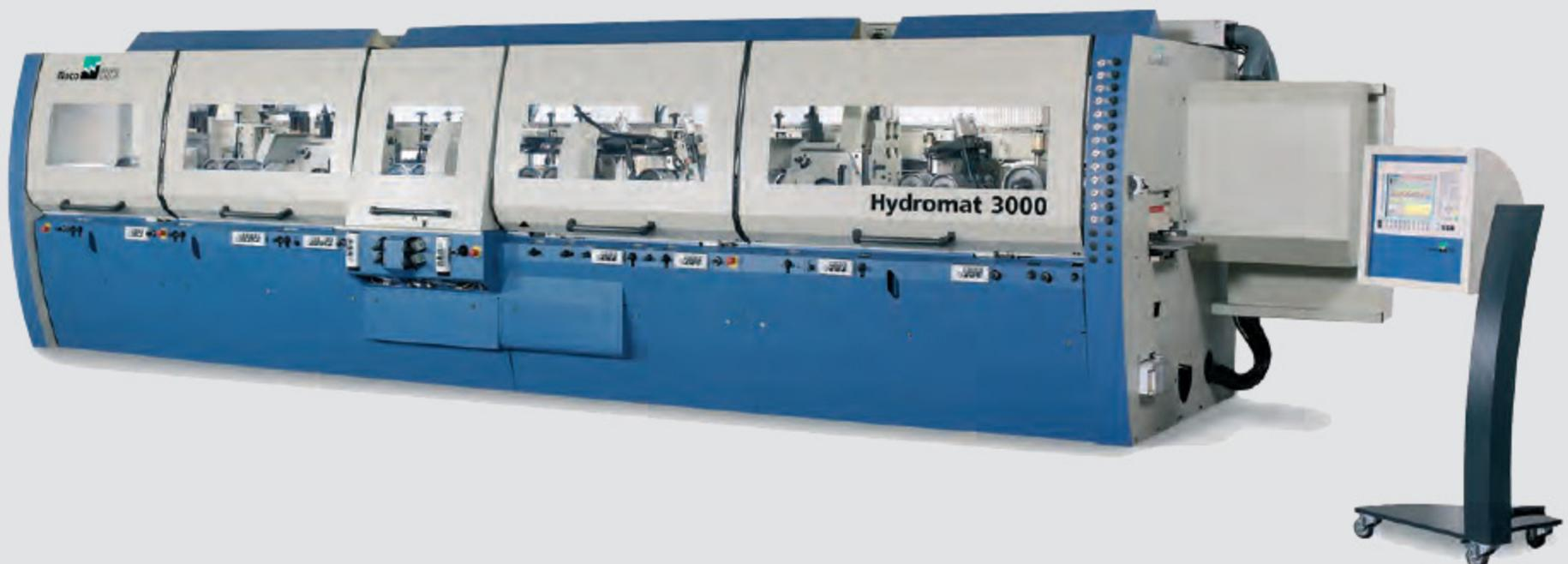
Die Hydromat 3000 ist genau die Richtige Hobelmaschine für Sie, wenn Sie Leisten und Paneele schneller und mit höchster Qualität produzieren wollen. Bis 20.000 m<sup>3</sup> sind pro Jahr und Schicht möglich. Mit dem Hydromat 3000 erzielen Sie eine überlegende Oberflächenqualität. Dazu tragen besonders die schweren Gusstände bei, die auch bei hohen Vorschubgeschwindigkeiten äußerst vibrationsarm bleiben.
