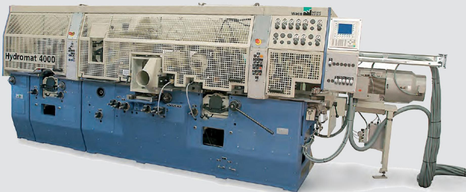
Die ideale Hobelmaschine für die Volumenproduktion von Bau- und Konstruktionsholz. Mit einer Vorschubgeschwindigkeit bis zu 150 m/min können jährlich im Einschichtbetrieb bis zu 30.000 m<sup>3</sup> produziert werden.
