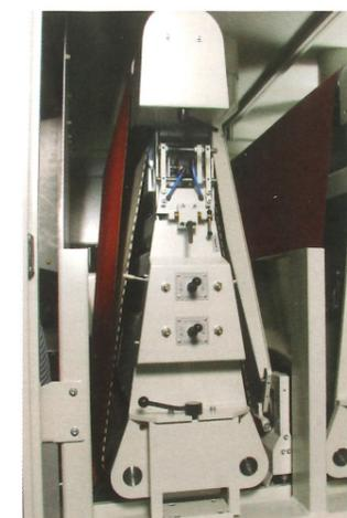
Breitbandstation mit separatem Lamellenband
