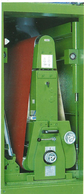
Kombistation mit mechanisch gesteuertem Schleifkissen und höhenverstellbarer Kontaktwalze.
