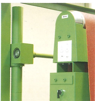
Die Höhenverstellung erfolgt zentral über Spindel und Schneckengetriebe. Robust, präzise, wartungsfrei.
