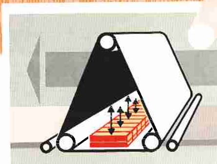
Schleifkissen in mikroprozessorgesteuerter Gliederdruckbalkenausführung.
