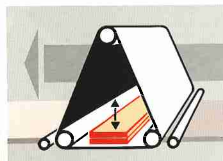
Schleifkissenaggregat mit elektrisch gesteuertem Schleifkissen und 80 mm breiter Filzauflage.
