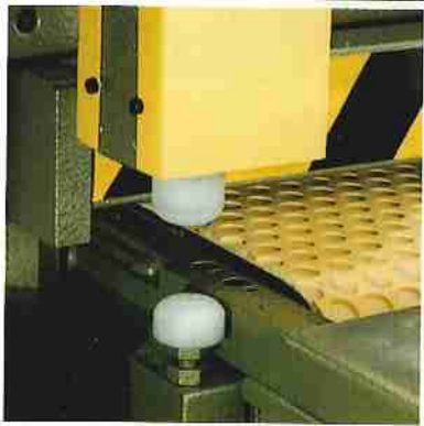
Automatische Werkstückdickenmessung, Einstellung mit höchster Präzision
