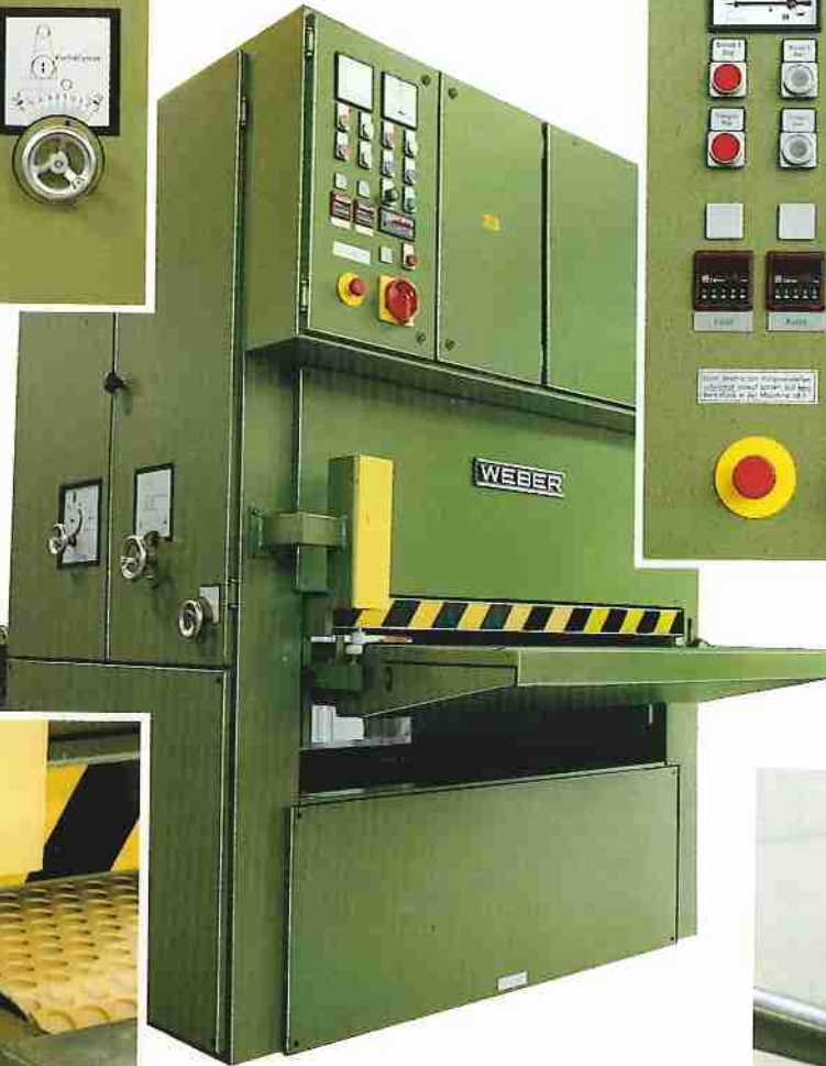
Schleifaggregat-einstellung außerhalb der Maschine
