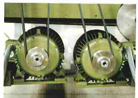
Keilriemenantrieb, wartungsfrei und selbstspannend
