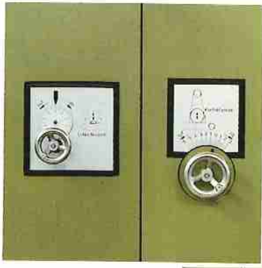
Schleifaggregat-einstellung außerhalb der Maschine
