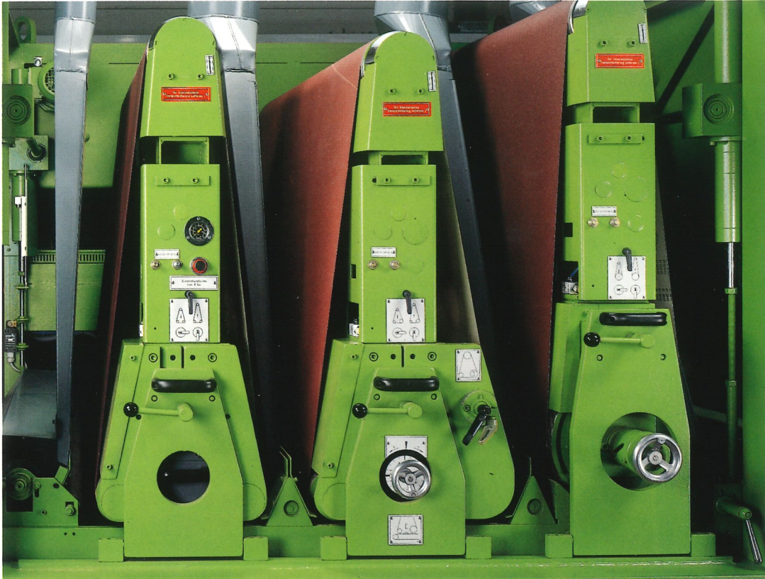
Dreibandschleifmaschine mit Großkontaktwalze zum Kalibrieren. Schleifkissenstation für Massivholz und Schleifkissenstation WEBER-MCS für Furnier
