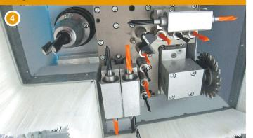
■ 8 Bohrspindeln vertikal
