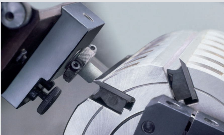
Fjärrmanövrerat rakbryne med automatisk uppmatning av brynsten
