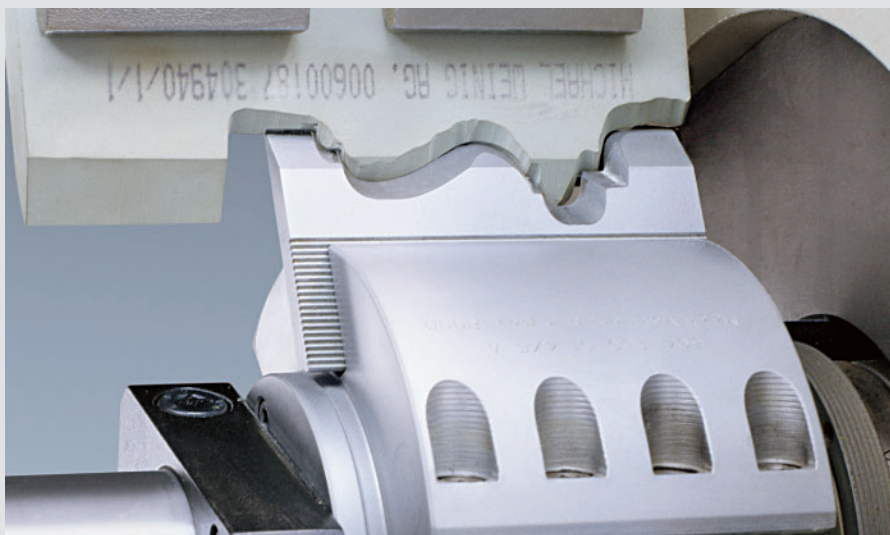
Fjärrmanövrerat profilbryne med automatisk uppmatning av brynsten
