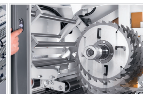
Un motore elettrico permette la registrazione in verticale dell'albero portalama: sistema molto comodo in produzione
