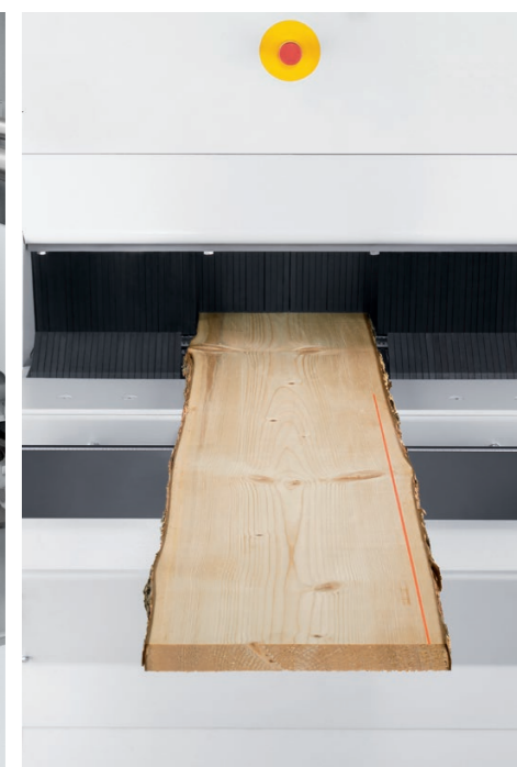
Raggio laser che indica la posizione della lama: il taglio diventa visibile
