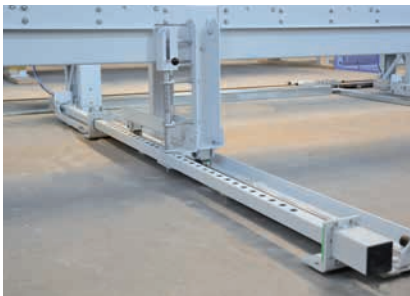
Präzisions-Führungsschiene für manuelle Breitenverstellung.
