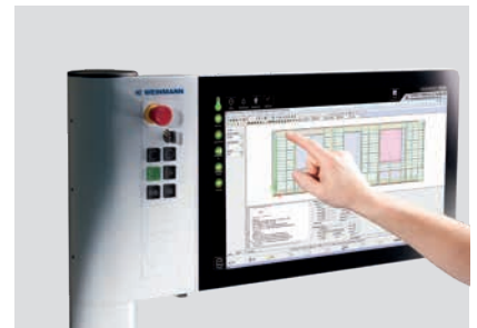
Über wupWorks 3 werden die CAD-Daten vollautomatisch umgewandelt und an die Maschine übertragen.
