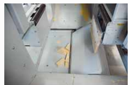
Automatische Gutteilensortierung für Werkstücke kleiner als 160 mm
