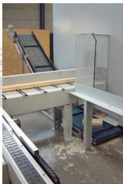
Förderband für die automatische Reststückentsorgung (Option)
