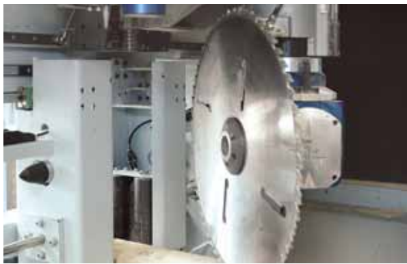
Winkelschnitt, Gerade- und Kervenschnitt (0 - 360° Drehwinkel)
