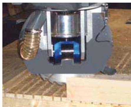
Sciage avec l'agrégat à 5 axes (Flex 5)
