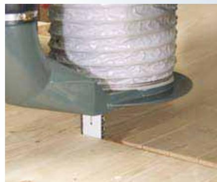
Sciage allant jusqu'à une profondeur de coupe d'env. 350 mm, avance selon le type et l'épaisseur du matériau
