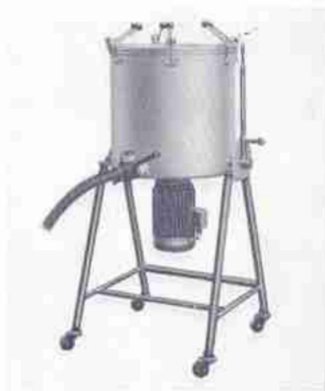
Leim-Rühr- und Leim-Schaumschlagmaschine Typ. SLRD 60 mit Druckluftentleerung
