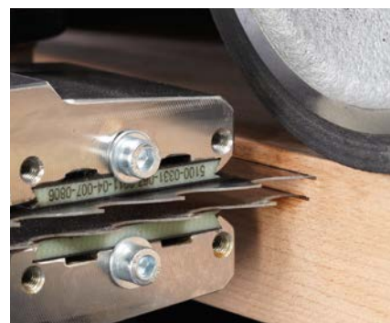
Ekstremalnie odporna na zużycie i ścieranie, zaawansowana technicznie prowadnica węglanowa
