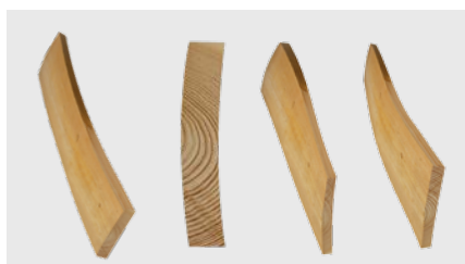
Заготовки с искривлениями в продольном и поперечном направлениях, углублениями и перекосами
