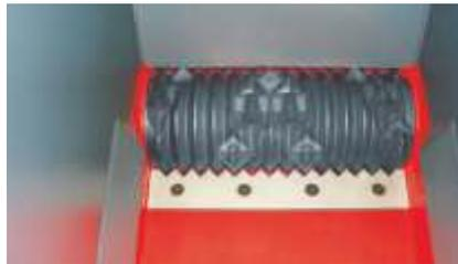
V-Rotor mit einer Messerreihe
