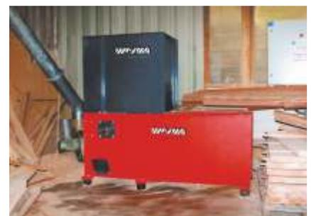
Zerkleinerer der Baureihe WL 4 S, zur Zerkleinerung von Restholz
