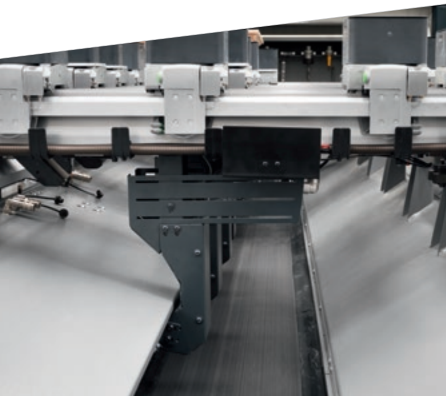
Alfombra motorizada para eliminar virutas y recortes.
